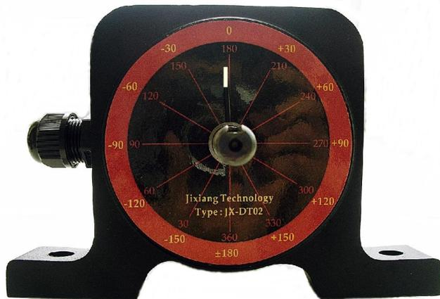
適用於任何機械結構之變位檢出器，安裝容易，接線方便，密閉式結構。
